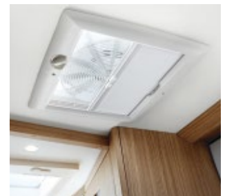
9403 Frischluftventilator über Küche
